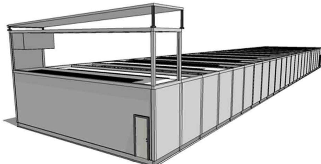
III、安装上部风道模块及防雨板拼装。
