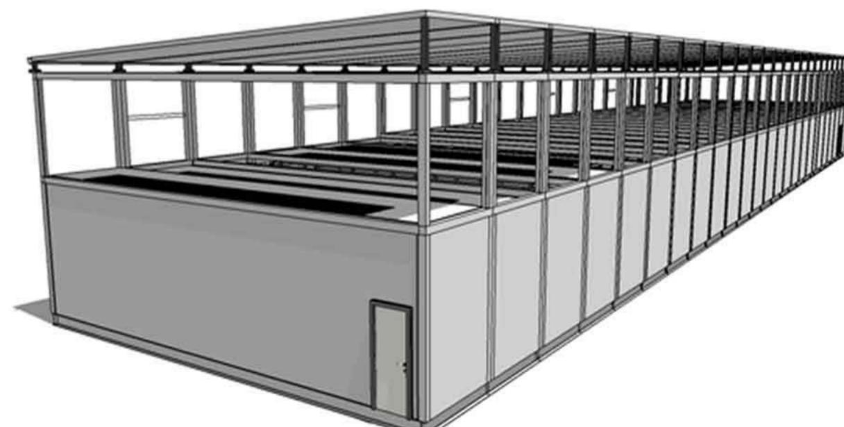
IV、完成所有上部风道模块及防雨板拼装。
